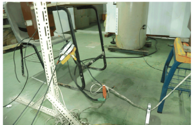
圖 6 高頻比流器檢測模鑄式比流器架設圖
