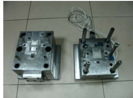
圖七 本研究製作完成之智慧卡模具
