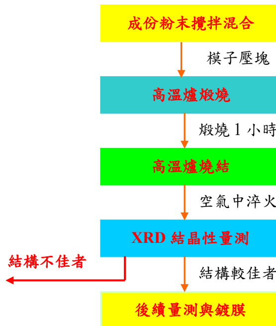
圖 3-2 粉末塊材試片製程流程圖
