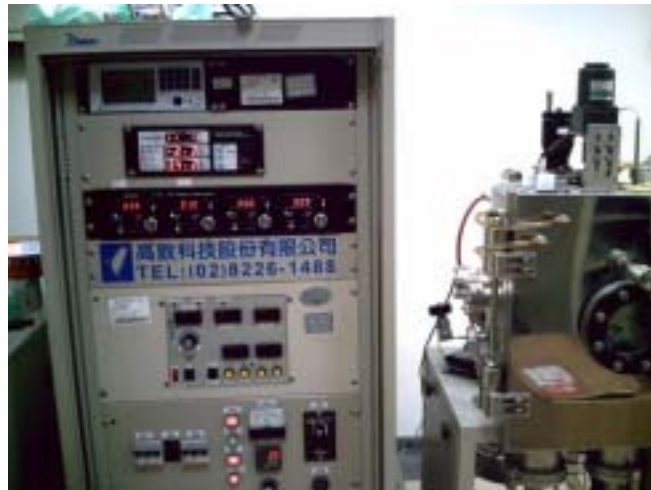
圖 3-3 本研究計畫所使用之薄膜濺鍍系統
