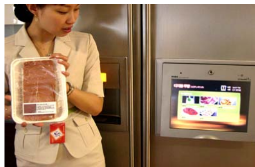
圖 3 內建 RFID 系統的智慧冰箱系統。
