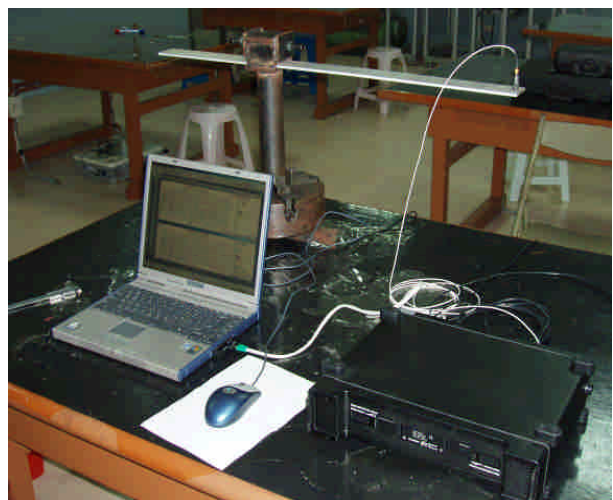
圖 11 懸臂樑自然頻率及模態測定系統
