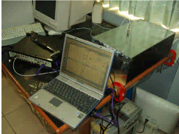
圖 12 簡支板自然頻率及模態測定系統
