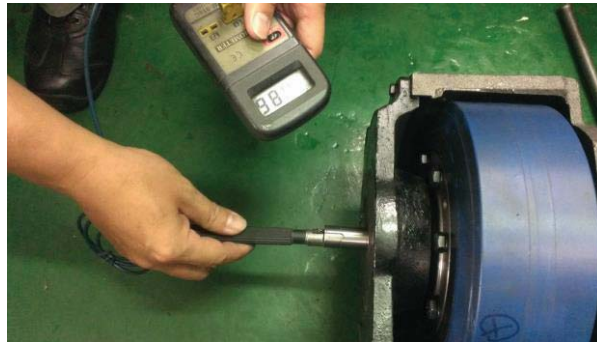
圖 1. 利用測溫器量測輸出軸表面溫度
