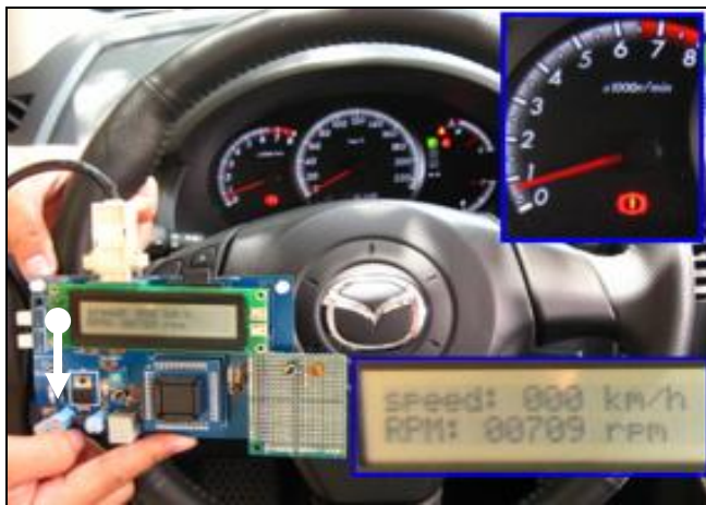
圖十四、讀取OBD資訊並與汽車儀表板所顯示之訊息進行比對
