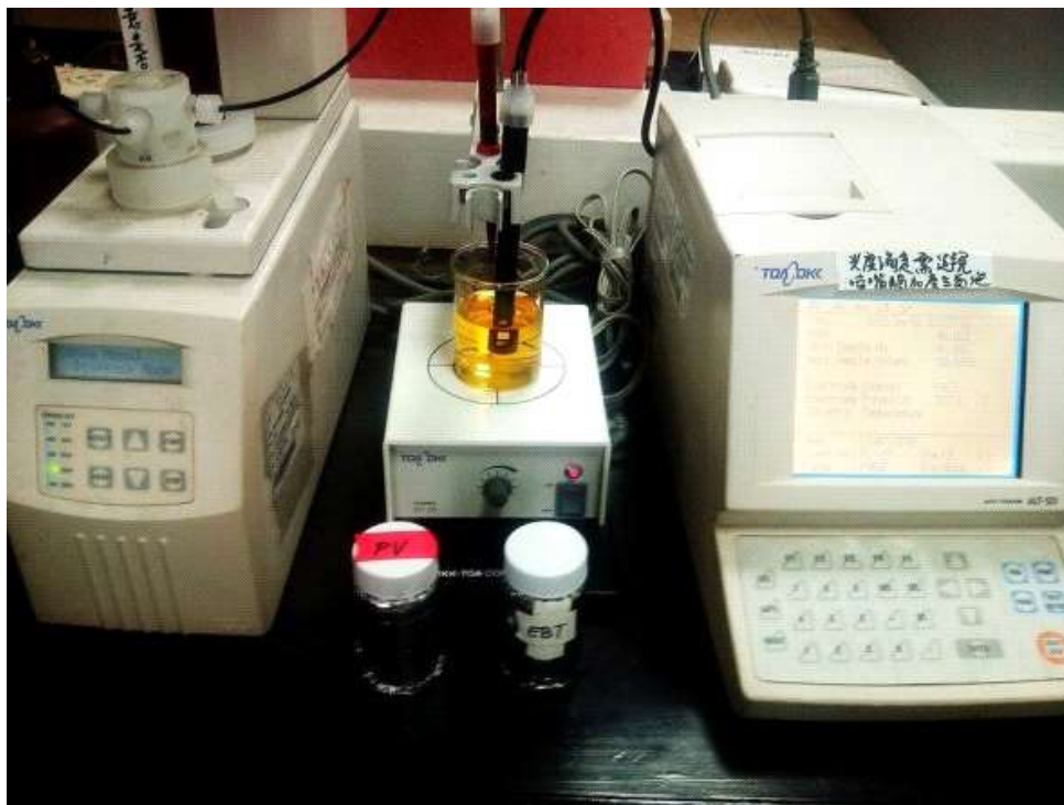
圖 3-1 TOA 自動滴定儀包括 AUT-501 主機(左)與 ABT-511 滴定控制器(右)，中間為脫泡噴嘴與光度滴定單元用浸入式探棒(黑色)
