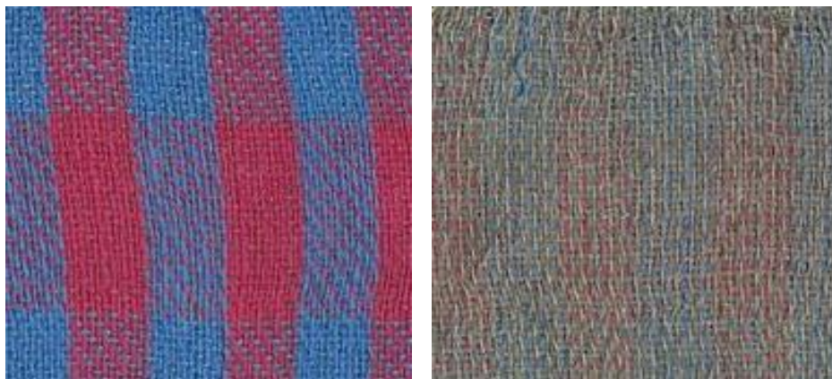
圖 4：裏經椰炭紗與一般紗以 1:1 配置樣布之正反面花紋圖， 樣布反面經紗部位呈現一半椰炭紗之黑色
