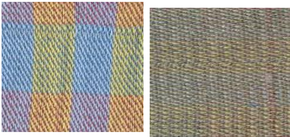
圖 7：裏經椰炭紗與一般紗以 1:3 配置，樣布之正反面花紋圖， 樣布反面經紗部位呈現更少椰炭紗之黑色
