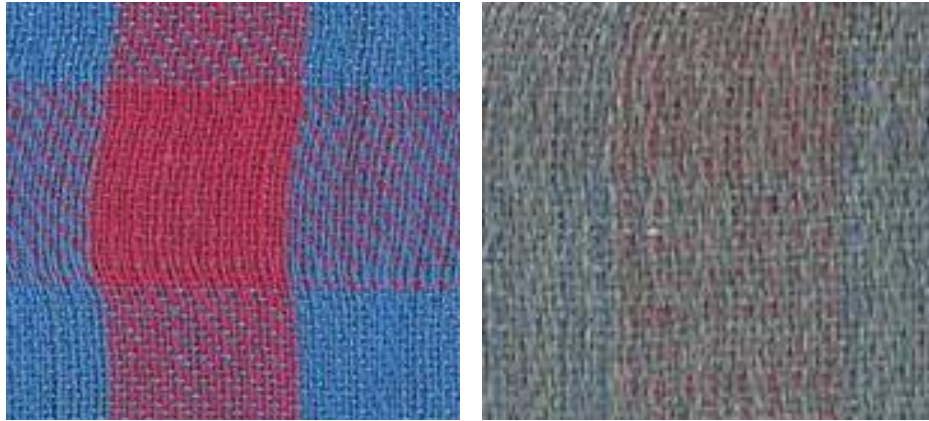
圖 3：裏經全部使用椰炭紗樣布之正反面花紋圖， 樣布反面經紗部位呈現椰炭紗之黑色
