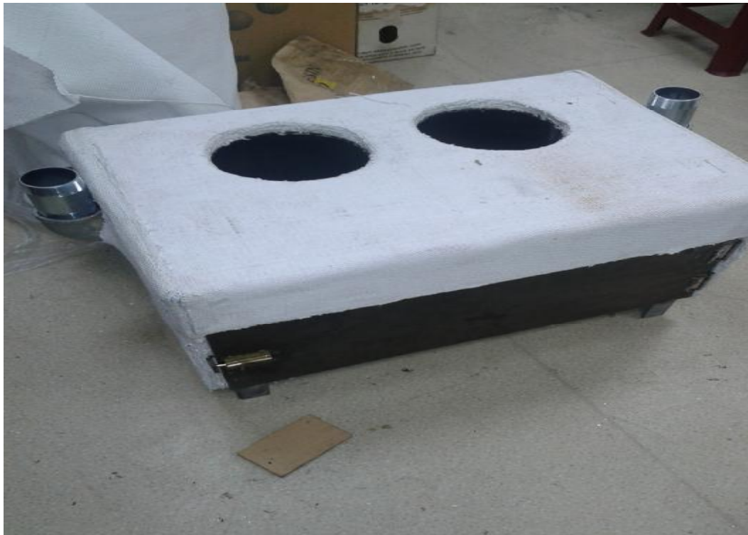
圖（十）已將工件使用隔熱石棉包覆的情形。
