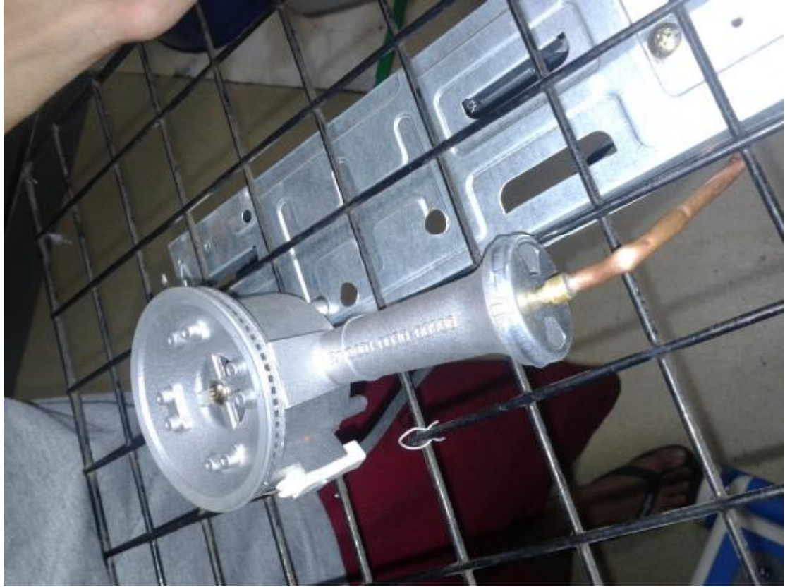
圖（八）把爐心以及瓦斯腳架和鐵網固定。
