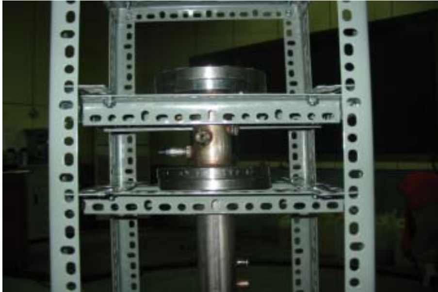
圖 6-4 將重組器本體安裝至架上
