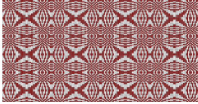
圖 15 以圖 14 斜紋與樣板搭配所產生之雙向曲線斜紋
