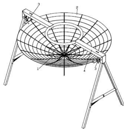
圖 2.1：日照時間測試圖(左圖)；聚光煮食器示意圖(右圖)
