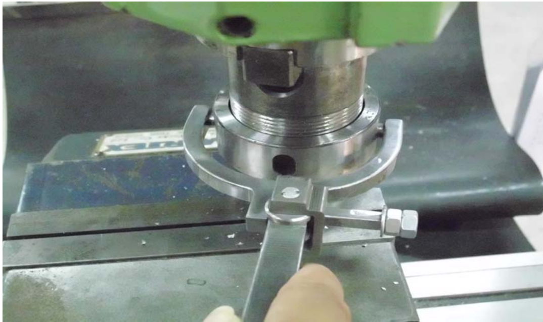
圖 3-15 安全勾型扳手成品之實際鎖緊圖
